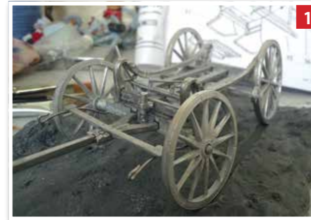
Die erste Vormontage zur Passungsprüfung der noch nicht lackierten Teile.
